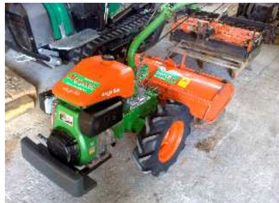
MOTOCULTEUR 11CV AGRIA avec rotovator, préparateur et charrue
